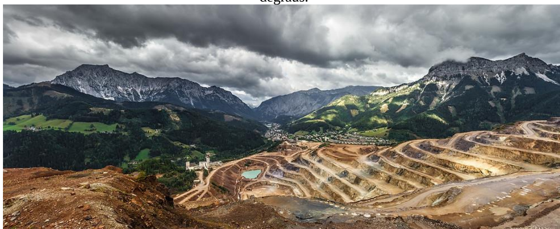
Figura 6 – Mina a céu aberto. Os cortes em blocos com dimensão padronizada e plataformas em degraus.
