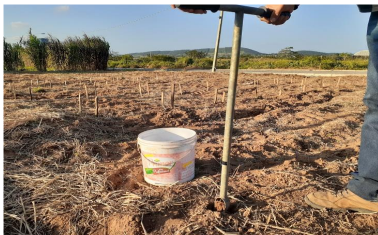
Figura 2 - Coleta de amostras simples do solo realizada no campo experimental da UFAL para análise química
