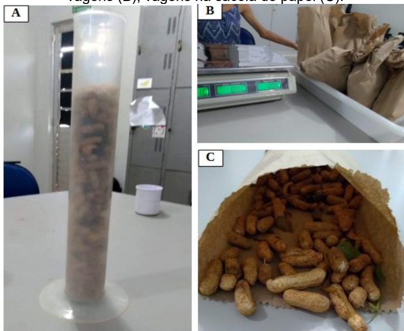
Figura 15 - Avaliação das vagens em laboratório: volume das vagens (A), peso verde das vagens (B), vagens na sacola de papel (C).
