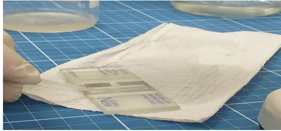
Figura 8 - Preparo da lâmina de Neubauer para contagem de esporos
