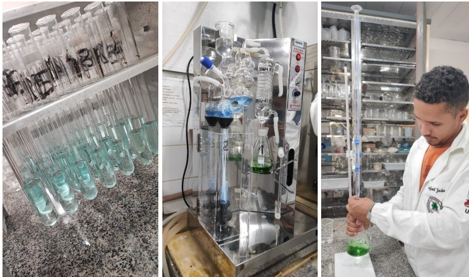
Figura 8 - Digestão, destilação e titulação de nitrogênio
