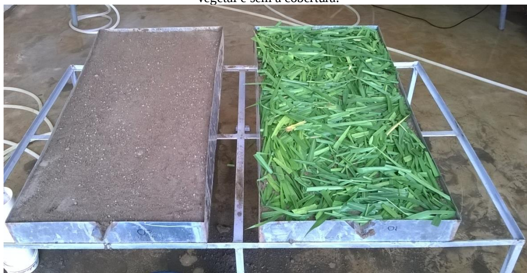
Figura 2 - Parcelas experimentais constituída de material metálico com Neossolo com a presença de cobertura vegetal e sem a cobertura.
