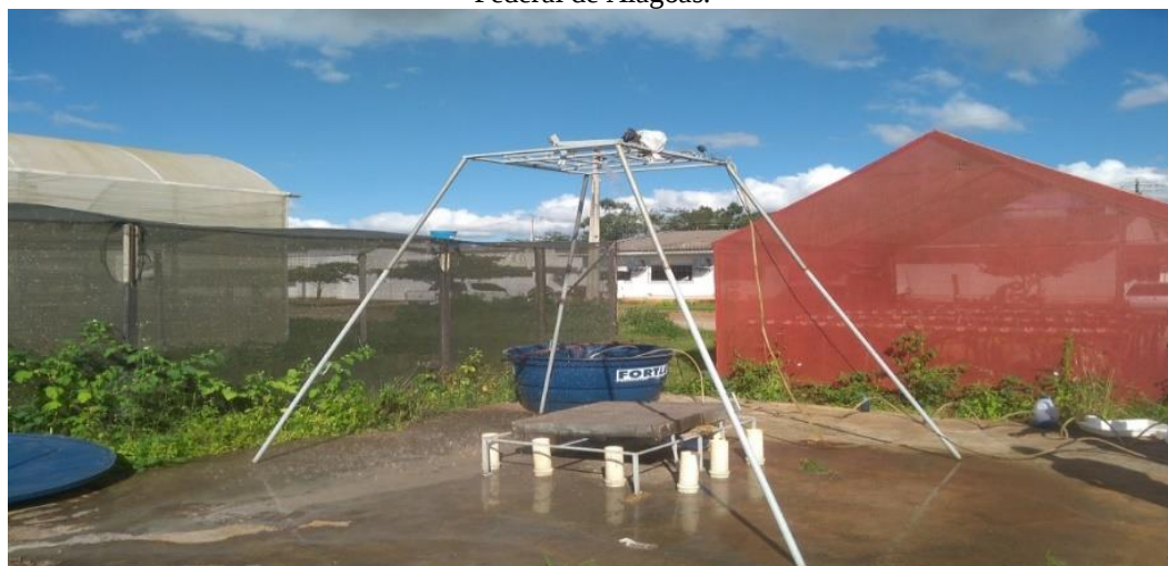
Figura 3 - Vista parcial do sistema de teste de chuva simulada, em operação nas dependências da Universidade Federal de Alagoas.
