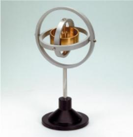
No giroscópio os conceitos físicos envolvidos no funcionamento do giroscópio são: momento angular, torque, precessão e rotação. Ele funciona se baseando na primeira lei de Newton, que, simplificando, diz que os corpos tendem a permanecer como estão, a não ser que uma força externa aja sobre eles, sendo uma roda central livre que gira em qualquer direção, cujo eixo de rotação mantém sempre a mesma direção na ausência de forças que o perturbem.
