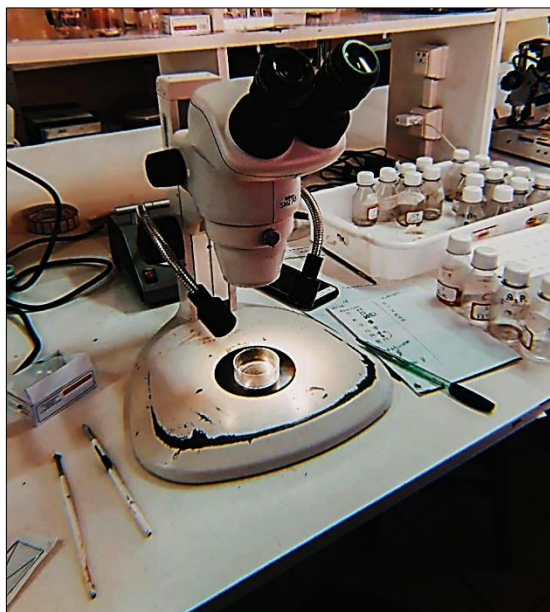
Figura 4 – Microscópico estereoscópico contendo amostra com ácaros para proceder a triagem e preparação de lâminas do material.
