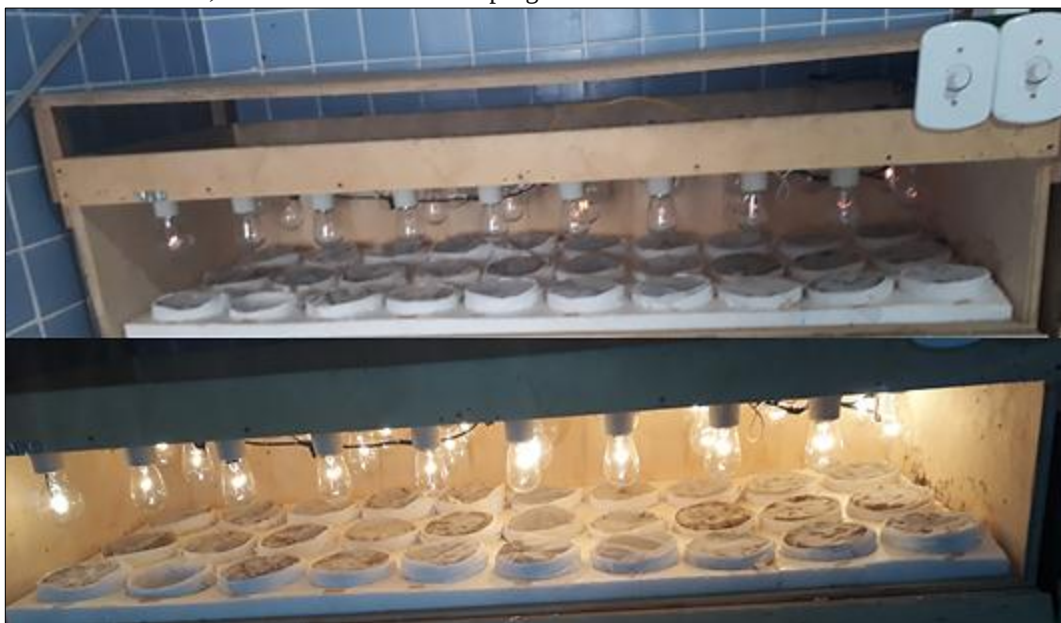
Figura 3 – Equipamento de Berlese-Tullgren modificado utilizado no processo de extração dos ácaros, evidenciando o aumento progressivo da luminosidade.
