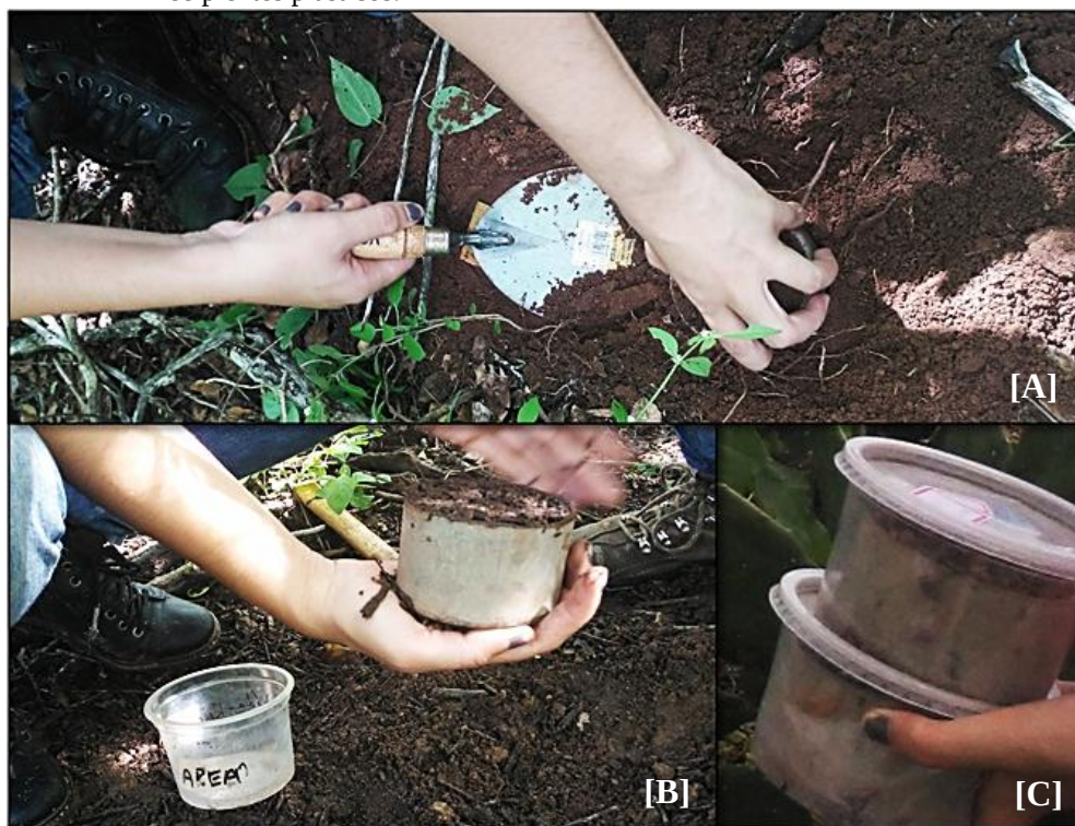
Figura 2 – Processo de coleta de solo nas áreas de estudo: A – Remoção de solo de forma indeformada com o auxílio de cilindros metálicos e espátula de aço. B – Cilindro metálico com solo coletado. C - solo coletado acomodado em recipientes plásticos.
