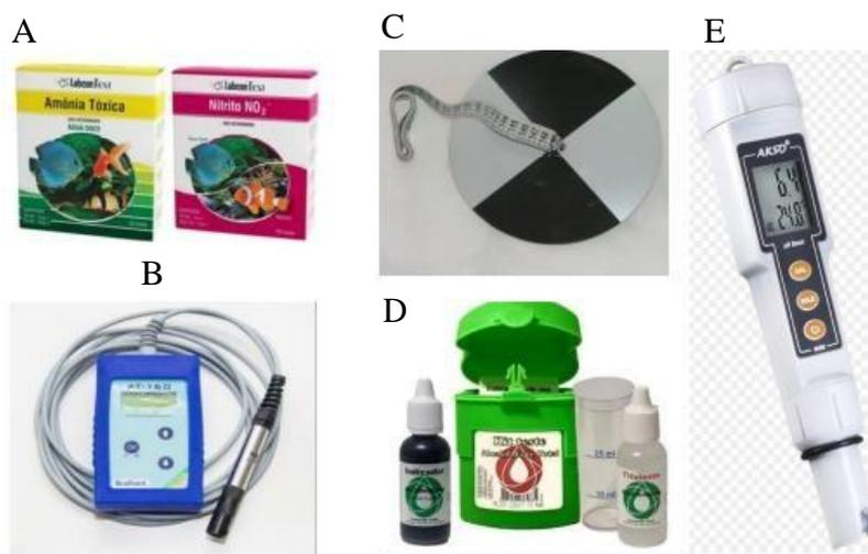
**Figura 10.** A. kit teste do LabconTest. B. Oxímetro da Alfakit AT160. C. Disco de Secchi. D. Kit para teste de Alcalinidade. E. Medidor de pH AKSO AK90 (Fonte: Google imagens)
